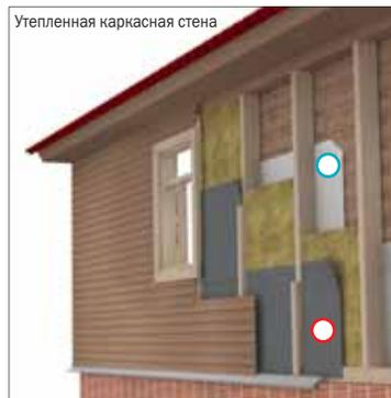
● Ондутис A120, A100, SA115 ● Пароизоляция
