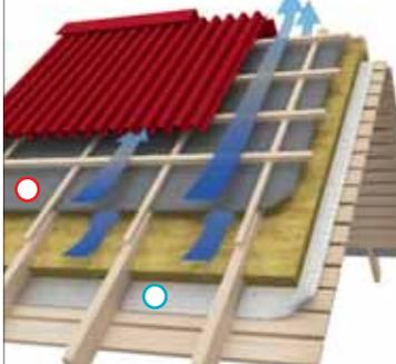
● Ондутис A120, RV100 ● Пароизоляция
