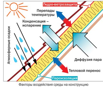
■ Для защиты утеплителя и строительных конструкций от отрицательных воздействий внешней среды (атмосферных осадков, холодного воздуха, уличной пыли) применяются **паропроницаемые ветро-влагозащитные пленки** или **диффузионные мембраны**. Эти материалы обладают свойством пропускать сквозь себя пар, выходящий из внутренних конструкций здания.
